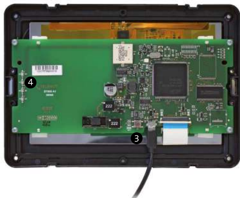
USB-Anschluss für das Firmware-Update
