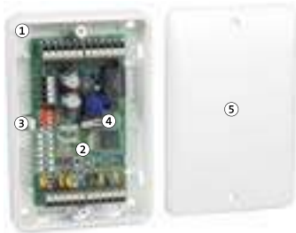
Mechanischer Aufbau Türmodul comlock 410 aP-Montage im Gehäusetyp K20
