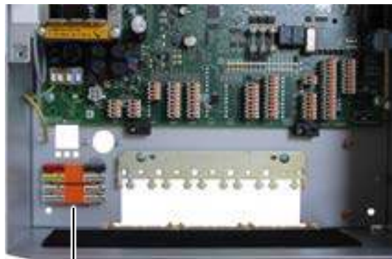
Befestigungsadapter mit MICRO-Verbindungsklemmen im Gehäusetyyp GR80 Abmessungen/Art.-Nr., siehe TELENOT-Website oder aktueller Produktkatalog
