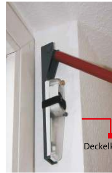
transparentes Gehäuseoberteil mit Deckelkontakt
