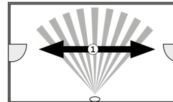
① Bewegungsrichtung für optimale Detektion
