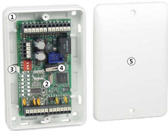
Mechanischer Aufbau Türmodul hilock 565 aP-Montage im Gehäusestyp K20
