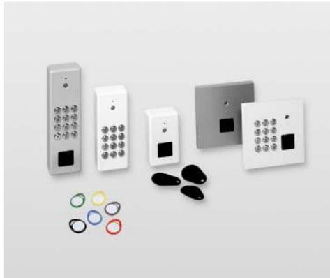
Das vier Meter lange Anschlusskabel ist fest mit dem Leser verbunden und kann bis zu 100 m verlängert werden. Werden mehrere Leser an einem Anschluss betrieben, darf die maximale Anschlusslänge 100 m nicht überschreiten. Bei größerer Kabellänge sinkt der elektrische Störabstand, wodurch die Datenübertragung beeinflusst werden kann und somit eine sichere Funktion nicht mehr gewährleistet ist.
