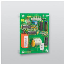
**Das Lichtschaltrelais dient zur Einschaltung von Beleuchtungen durch eine Einbruchmelderzentrale oder durch manuelle Schaltvorgänge.**
