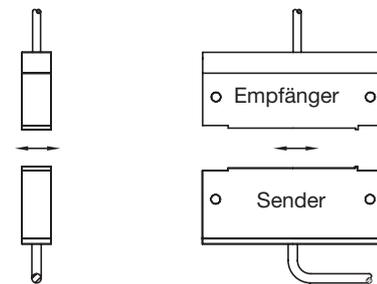
seitlicher Montageversatz max. 3 mm
