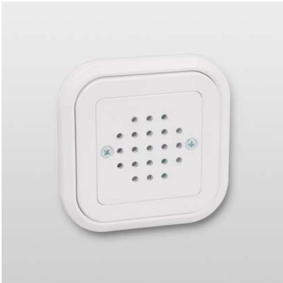
Der Intern-Signalgeber IS 12 dient zur Internalarmierung in Einbruchmeldeanlagen und ist zur Aufputz- oder Unterputzmontage in Innenräumen vorgesehen. Der Signalgeber ist durch einen Sabotagekontakt geschützt. Sein ansprechendes Design erlaubt die Anbringung im Sichtbereich. Der Signalgeber gibt ein kontinuierliches, lautstarkes und durchdringendes Signal ab.
