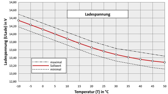
Verschiedene Ladenetzteile besitzen eine Akku-Überwachungsschaltung, die ständig die am Akku anstehende Spannung kontrolliert.
