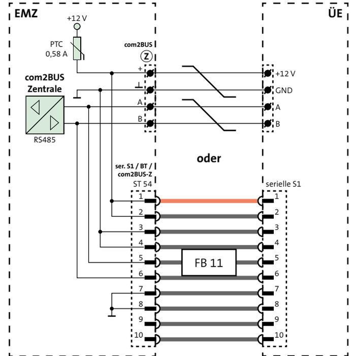
Anschlusschema Schnittstelle ser. S1 / BT / com2BUS-Z
