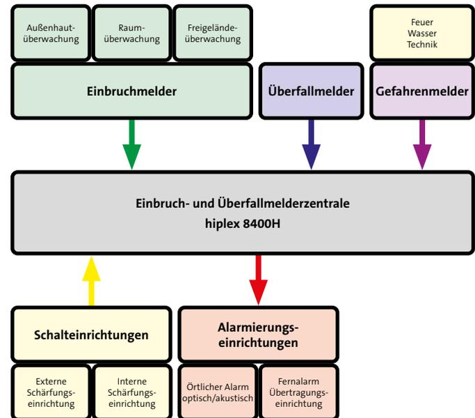
Abb.: Aufbau einer Einbruch- und Überfallmeldeanlage
