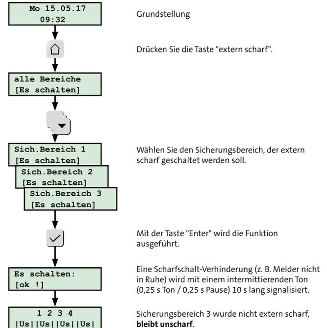
Abb.: Scharfschaltversuch über Bedienteil
