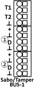
Abb.: Anschlussbelegung Deckelkontakt, Abreißmelder und BUS-1 (1/2)
