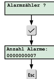
Menü "Alarmzähler" wird mit der Taste "Enter" geöffnet.
