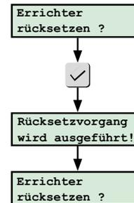
Funktion "Errichter rücksetzen" wird nach dem Drücken der Taste "Enter" ausgeführt.
