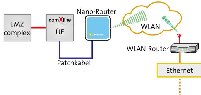
Einbindung des WLAN-Adapters WLAN-2 in ein Einbruchmeldesystem
