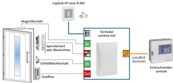
Einbindung des comlock 410 in der Betriebsart Türmodul in ein Einbruchmeldesystem
