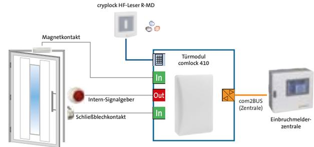
Einbindung des comlock 410 in der Betriebsart Tagalarm in ein Einbruchmeldesystem
