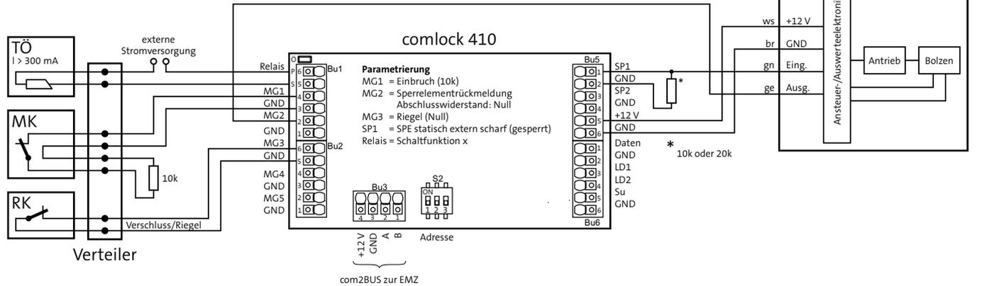
Anschaltbeispiel Betriebsart Türmodul mit Sperrelement Easy Lock 8360
