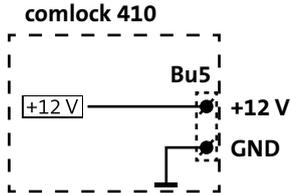
Anschlussschema 12-V-Versorgungsspannung für Leser, Blockschloss, Sperrelement usw.
