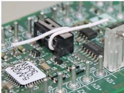
Die Adresse für BUS-1-Komponenten kann zwischen 1 und 63 am **DIP-Schalter S1** eingestellt werden. Um die gewünschte Adresse zu erhalten, müssen alle Zahlen (Werte unter dem Schalter), deren Schalter auf „ON“ stehen, addiert werden.
