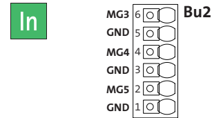
Anschlussbelegung Meldergruppen (In) MG3 bis MG5 (Bu2)
