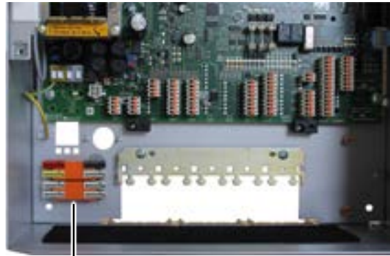
Befestigungsadapter mit MICRO-Verbindungsklemmen im Gehäusotyp GR80 Abmessungen/Art.-Nr., siehe TELENOT-Website oder aktueller Produktkatalog
