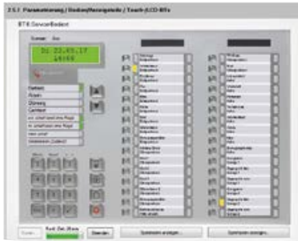
Ferndiagnose: Service-Bedienteil-Simulation mit Parametriersoftware compasX
