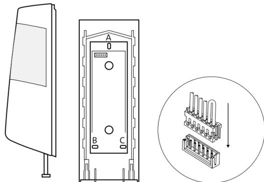
Für die Inbetriebnahme Steckverbindung zum gewünschten Steckplatz ST1/ST2 auf der Platine herstellen.
