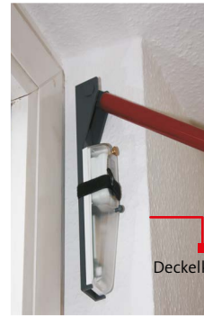
transparentes Gehäuseoberteil mit Deckelkontakt
