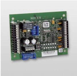
Das Türmodul comlock 410 UFM dient zum Anschluss der gesamten Peripherie einer Zugangstür an das Universelle Funkmodul UFM 260.
